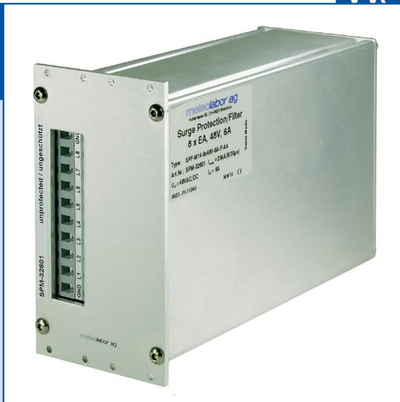
Das Überspannungsschutzmodul SPM-32601 ist ausgelegt für den Schutz von acht Stromversorgungsleitungen mit Maximalströmen von bis zu je 6 A bei Spannungen bis maximal  $\pm 48$  V AC oder DC. Zusätzlich sind zwei GND-Klemmen vorhanden für den allfälligen Anschluss eines Schirms.
