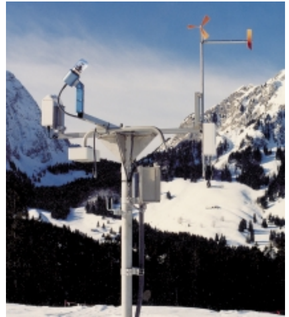
Meteomast mit Sensoren für Wind, Strahlung, Helligkeit und Temperatur im Alptal bei Einsiedeln
